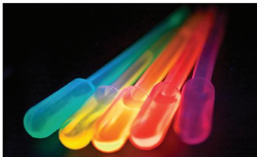
*Puntos cuánticos son nanopartículas semiconductoras cuyo tamaño y composición se pueden afinar individualmente para absorber frecuencias específicas de luz y hacerlas sensibles a varias frecuencias, entonces se puede construir en una sola celda solar para absorber un espectro de luz solar más amplio.*
