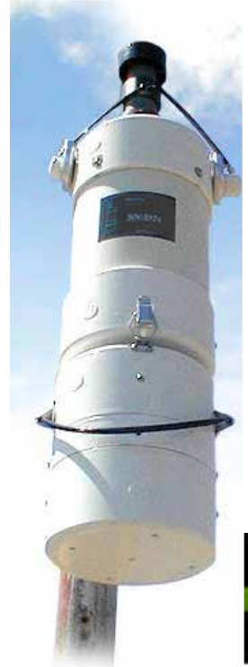
Minivol Sampler: 5 L/min
