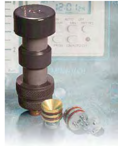
Minivol Sampler: 5 L/min
