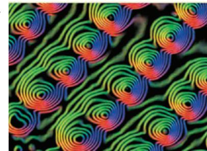
*El microscopio electrónico crea imágenes altamente magnificadas al grabar como un haz de electrones interactúa con un material de muestra. La imagen arriba es un ejemplo, mostrando níquel magnético nanoestructurado. Tales materiales se podrán usar algún día para almacenar datos, electrónicos, biomedicina y telecomunicaciones.*
